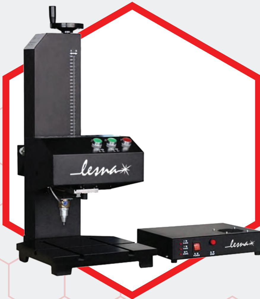
**Dot - A** necessita di un attacco all'aria compressa e di un computer per funzionare. La struttura è costruita per essere duratura e solida, il basamento in ghisa garantisce un'ottima stabilità.
