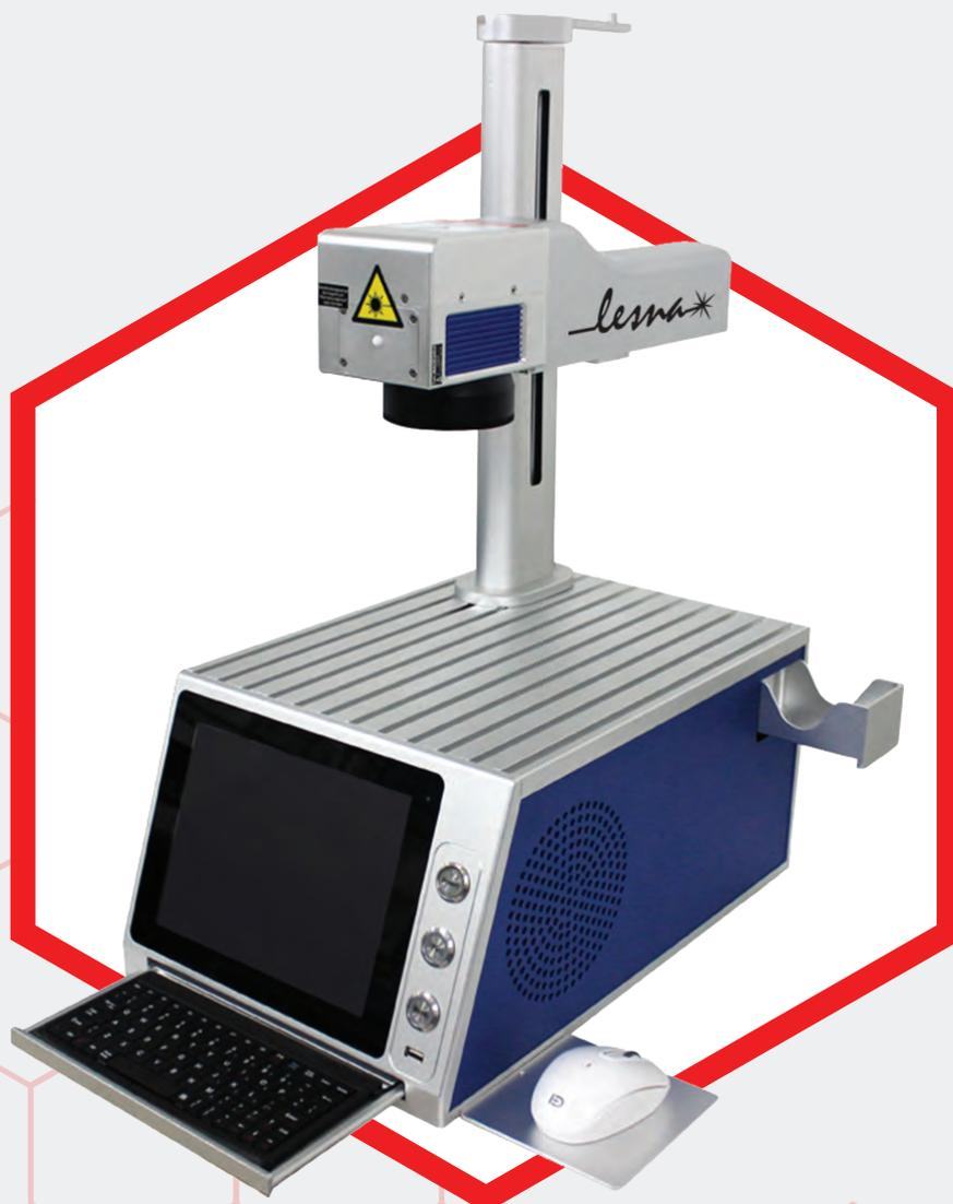
**Laser - P è un sistema di marcatura ideale per lotti medio-piccoli. Questa macchina è stata progettata per essere facilmente smontabile e trasportabile, all'interno dell'apposita valigetta. La compattezza rende questo sistema perfetto per essere montato su un banco di lavoro. Il design del prodotto rende possibile richiudere mouse e tastiera all'interno della scocca.**
