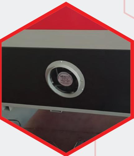
Sul retro della macchina è installato un sistema di aspirazione che elimina le polveri create durante il taglio.
