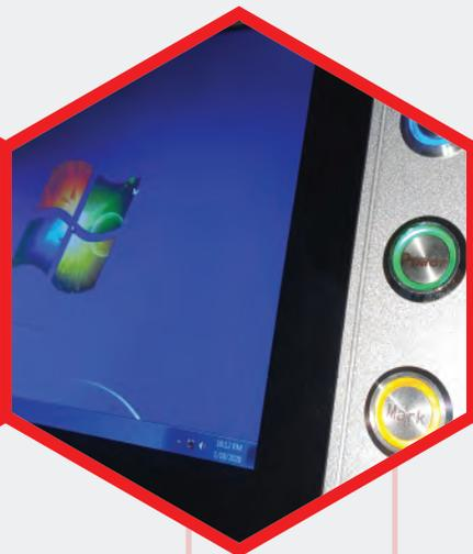
Il pc incorporato nel laser è di tipologia all-in-one, con sistema operativo windows e schermo touch screen.
