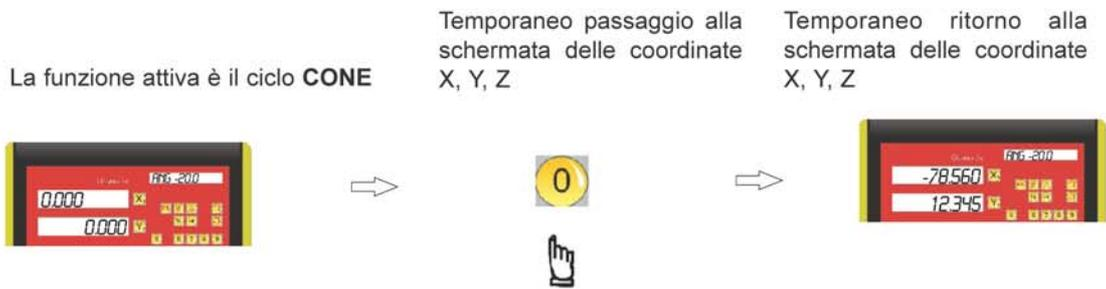
Ripristino del ciclo **CONE** per continuare le operazioni di allineamento angolare inclinato **INCL**
