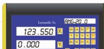
La posizione di zero dell'asse Y segue la posizione dell'asse X fino all'angolo di ANG (-20 gradi in questo esempio), l'asse Y può essere spostato fino al raggiungimento della quota = 0.000; a questo punto l'asse Y si trova nella posizione 20 gradi.
