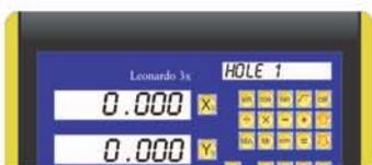
Temporaneo passaggio alla visualizzazione delle coordinate X, Y, Z
