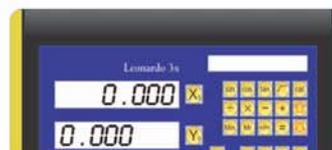
In modalità INC il valore di Y è impostato in accordo con il valore  $X \cdot \tan(\text{ANG})$ ; l'azzeramento del valore dell'asse X cancella anche quello dell'asse Y
